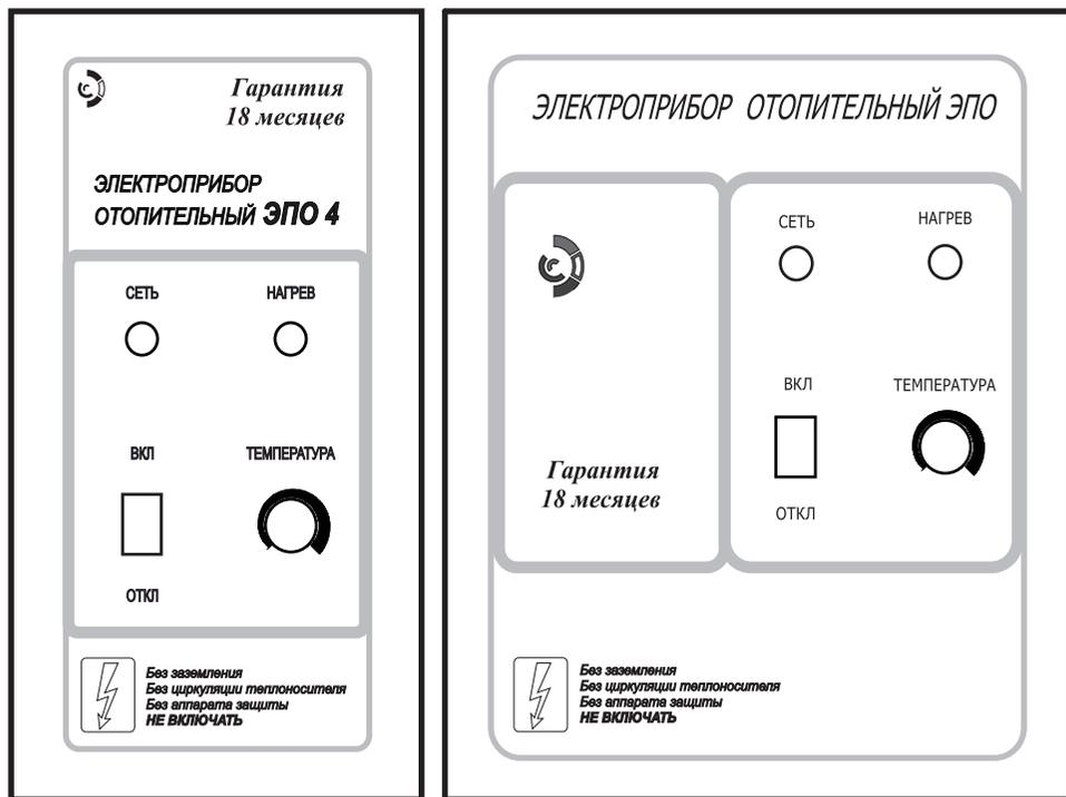
Рисунок 3. Пульты управления ПУ ЭПО-М1-4 и ПУ ЭПО-М1-6-30
